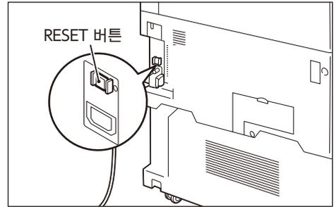
3. 펜 촉과 같이 끝이 뾰족한 물건으로 TEST 버튼을 가볍게 누릅니다. 눌린 상태의 RESET 버튼이 다시 튀어 나옵니다. 이제 누전 차단기 점검이 끝났습니다.
