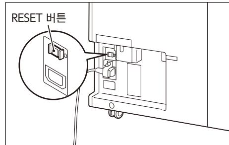
**3. 펜 촉과 같이 뾰족한 물건으로 TEST 버튼을 가볍게 누릅니다. 눌린 상태의 RESET 버튼이 다시 튀어 나옵니다. 이제 누전 차단기 점검이 끝났습니다.**
